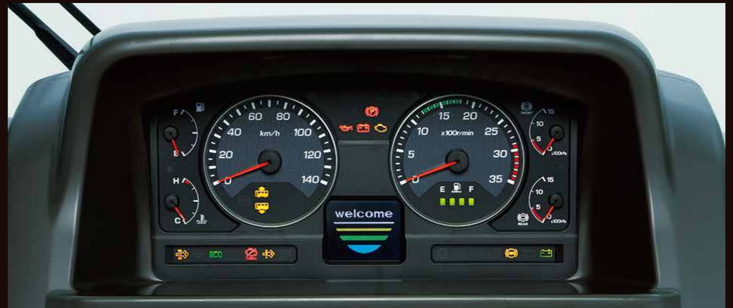
■ Ivis (アイヴィス) を備えた、視認性に優れたメータークラスター ※説明のためインジケータ類を点灯させています。
