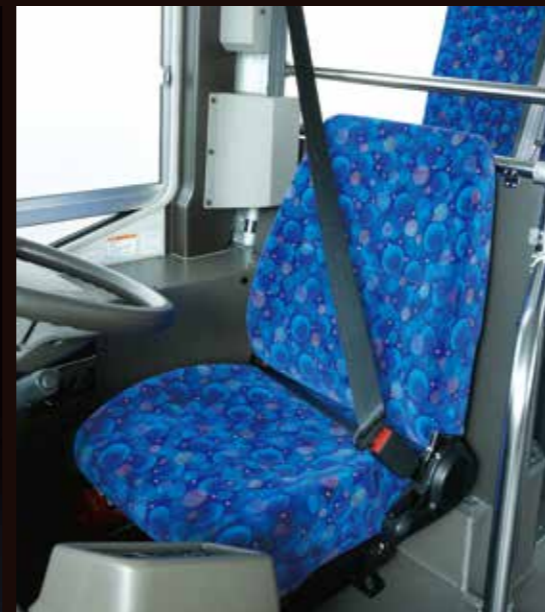
■ 運転席3点多重感知式ELR付シートベルト
