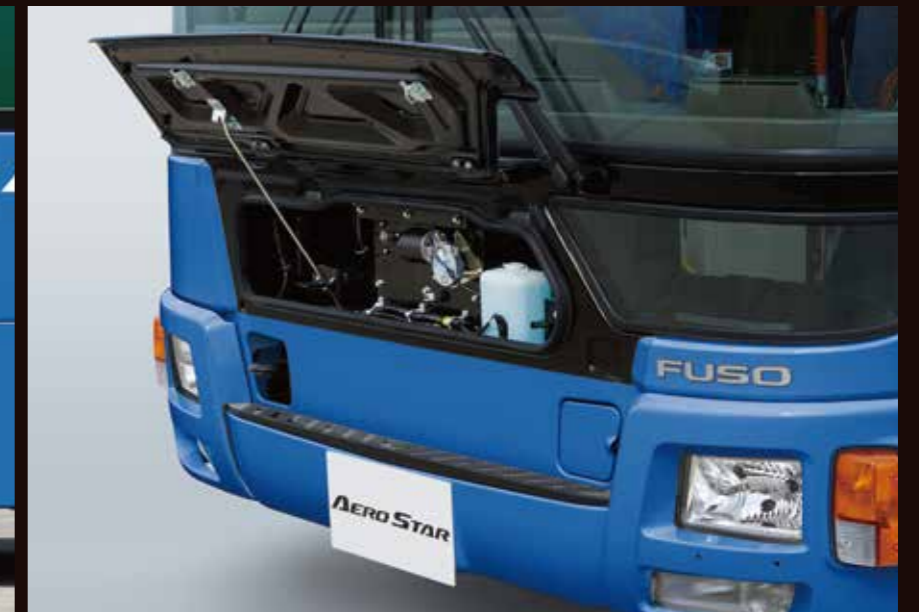
■ バンパーステップ/ワンタッチ式フロント点検リッド
