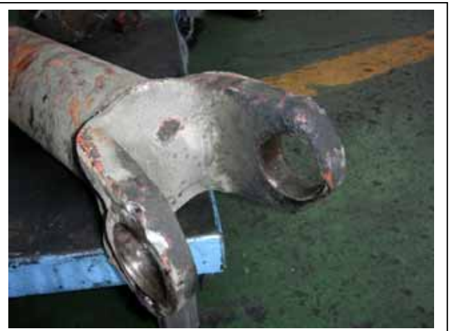
4 ペラ後側(デフ側) フランジヨークはデフ側に残存。口が広がっている。ニードルベアリングは行方不明。
