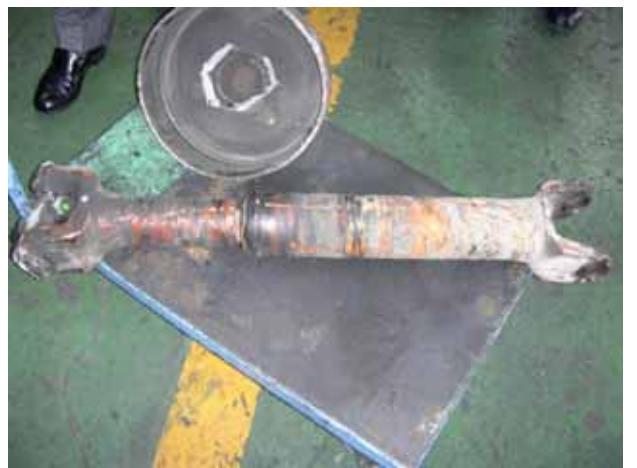
2 駐車ブレーキドラム、プロペラシャフト
