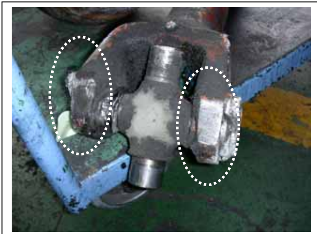
3 ペラ前側(T / M) 引きずられて路面と擦れた跡有り。
