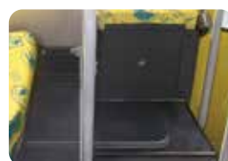
バッテリー点検リッド (台上げ部に設置)
