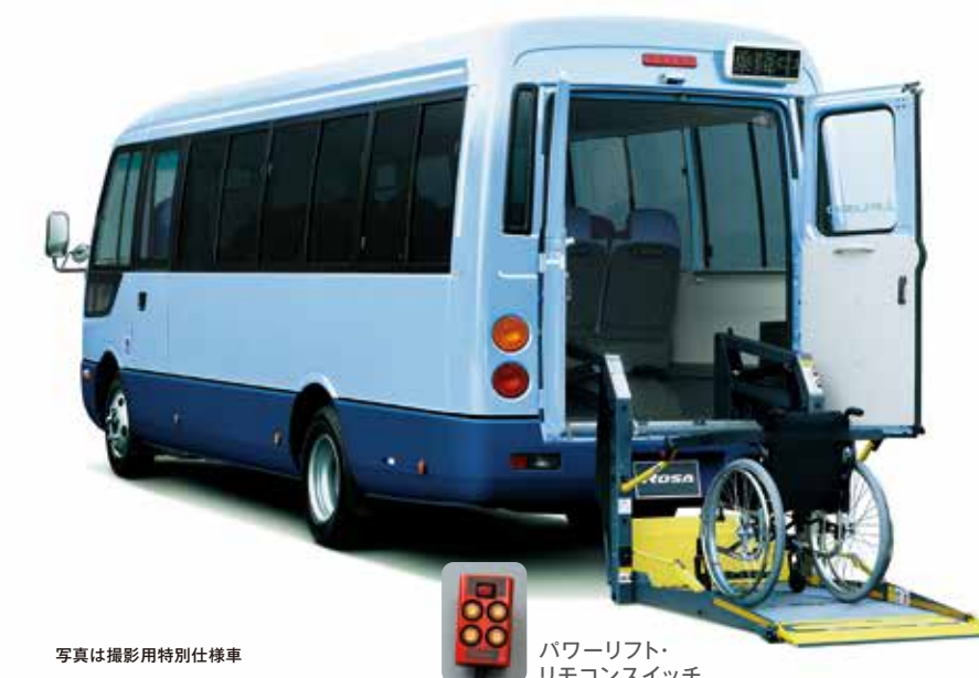
プラットホームストッパー 自動落下防止装置の動作状況。
