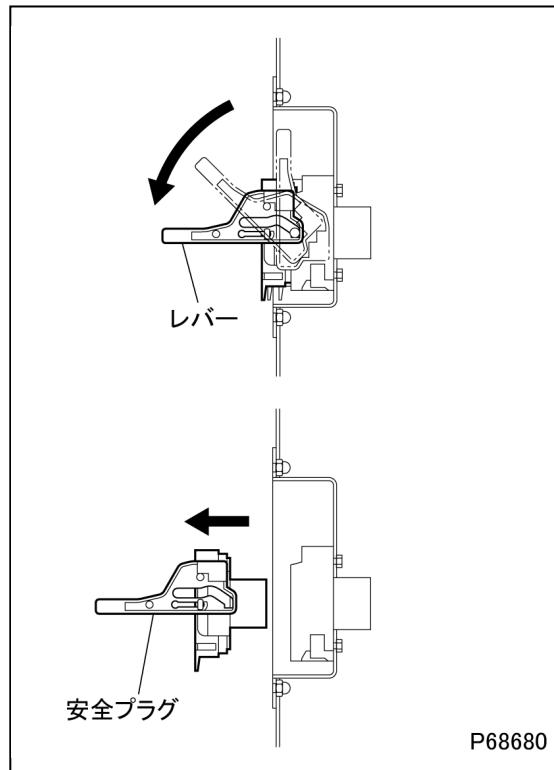
次に安全プラグをまっすぐ引き抜き、駆動用リチウムイオン電池から取り外します。
