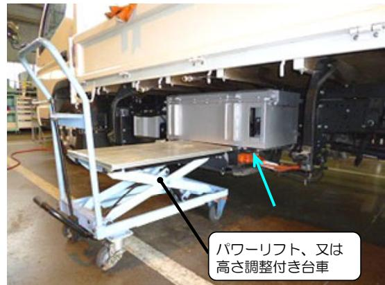
途中、駆動用リチウムイオン電池下側の後方内側位置決め突起が車両の冷却水パイプに当たる為、電池を持ち上げながらパイプを避け、リフトへ移動させます。
