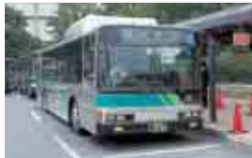
エアロスターノンステップHEV (シリーズ式ハイブリッドシステム搭載)
