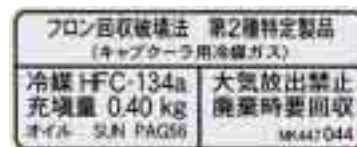
フロン回収破壊法対応 注意ラベル
