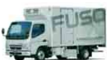
キャンターHEV (平行式ハイブリッドシステム搭載)
