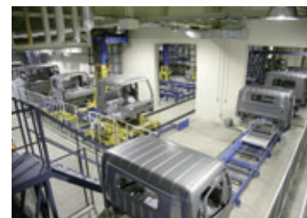
1 溶接ラインで組み立てられたキャブが塗装工程に搬入される。
