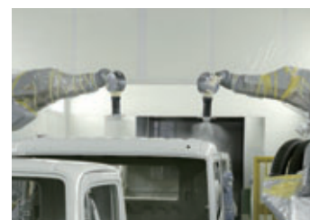
10 塗色に塗られる「上塗り」工程。VOCの発生を抑制し、その回収も行う。
