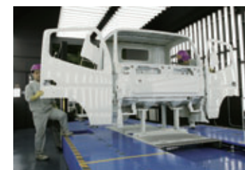
12 塗装を完了したキャブに最終検査が施される。
