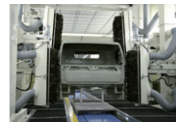
9 上塗り塗装の直前に、ワイブ装置で埃や異物が取り除かれる。
