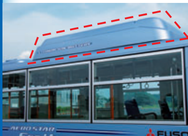
ルーフ上のリチウムイオン電池ボックス
