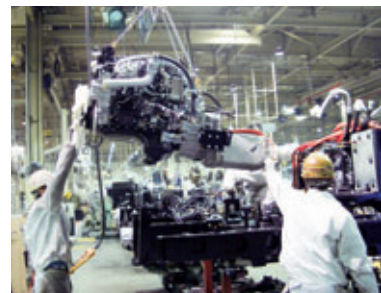
エンジン・モーター部の取り付け
