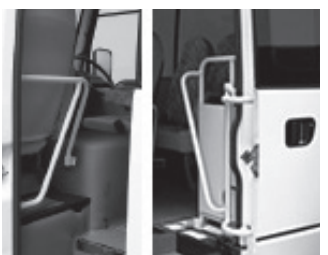
乗降口両側手すり
