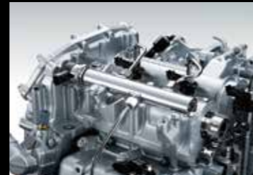
3 コモンレール式高圧燃料噴射システム
