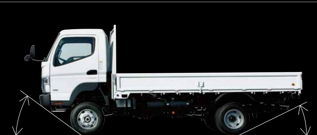
■ アプローチアングル/デパーチャアングル (ワイドキャブ高床車)
