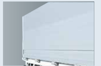
薄型アオリ(25mm幅): 標準荷台、拡幅荷台
