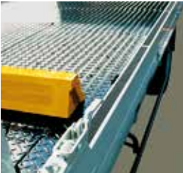
4 開閉式横アオリ(角パイプ:スチール) H100mm×W50mm
