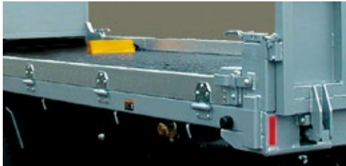
5 開閉式横アオリ(アルミ) H100mm×W50mm
