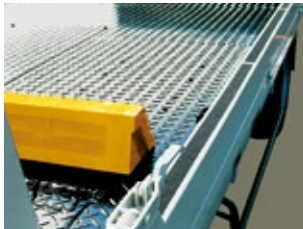
4 開閉式横アオリ(角パイプ:スチール) H100mm×W50mm
