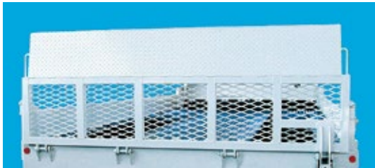
7 スチール製短尺・全面エキスパンド H750mm
