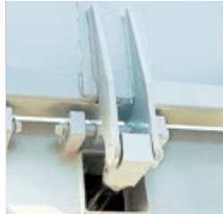
8 油圧開閉式リヤゲート(シリンダーシングル)
