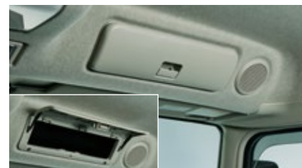
オーバーヘッドコンソールボックス (1DIN) * 運転席側:標準装備 / 助手席側:プレミアム・ラインに標準装備、プロ・ライン、エコ・ラインにメーカーオプション。 *ハイルーフは仕様異なります。
